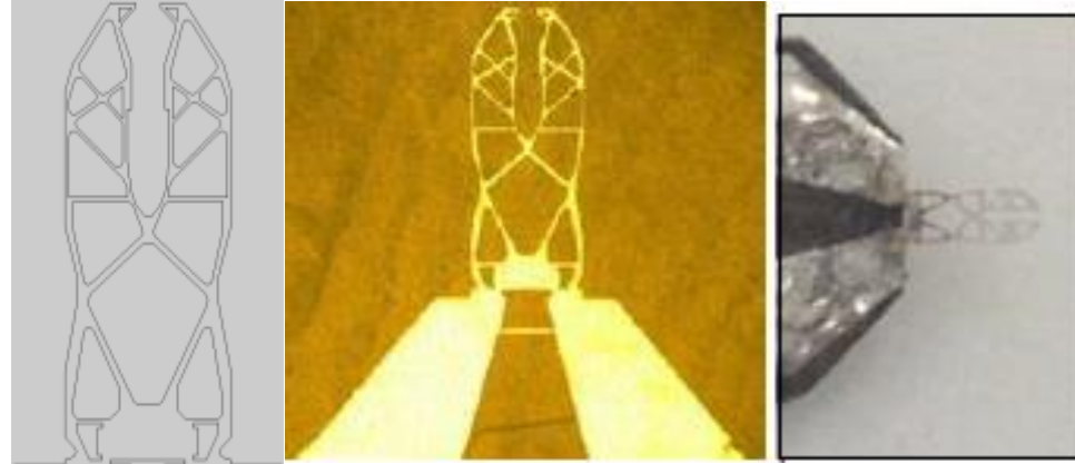
CADレイアウトと製作されたグリッパー、デジタル顕微鏡
